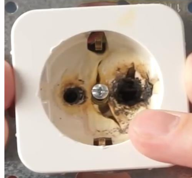
Jatkuvassa kuormituksessa oleva pistorasia voi ylikuumentua ja aiheuttaa palovaaran
