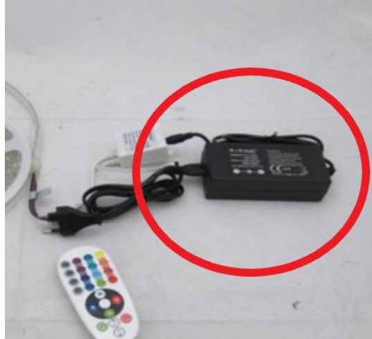
LED-nauhan liitännälaitte. Myös paljaan toisioliittimen voi irrottaa käsiteltäväksi.
