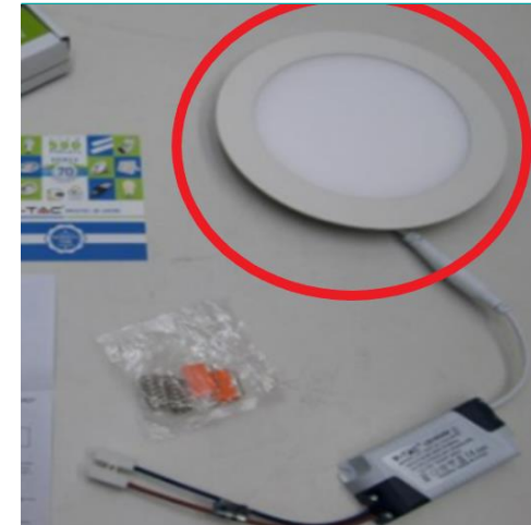
Valaisinosassa LED-moduulin ja metalliosien välinen pintaväli noin 0,3 mm (riittävä, jos liitännälaitteen eristys on OK).
