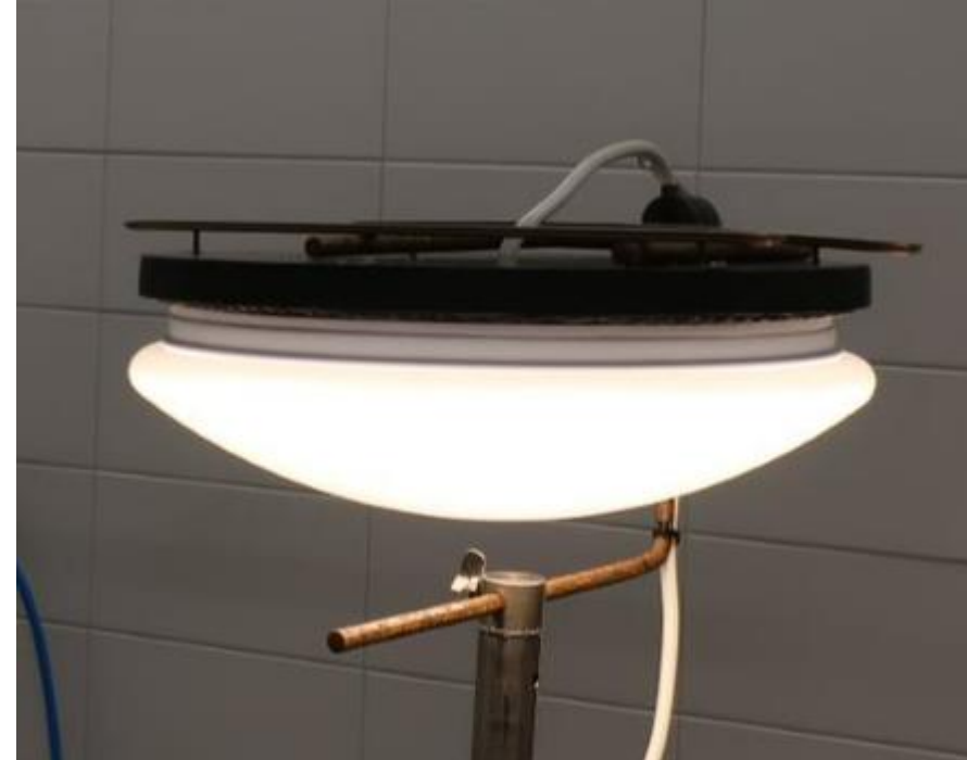
IPX4-testattava kattovalaisin, asennuslevy mitoitettu
